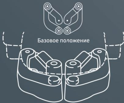
Поворотный механизм панели управления
